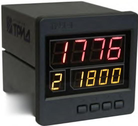
Регуляторы температуры ТРИД РТ осуществляют измерение, индикацию и регулирование технологического параметра по двухпозиционному закону. При регулировании температуры прибор может управлять нагревателем, охладителем, либо работать в режиме нагрев-охлаждение, одновременно управляя нагревателем и охладителем, подключенным к разным выходам прибора.
